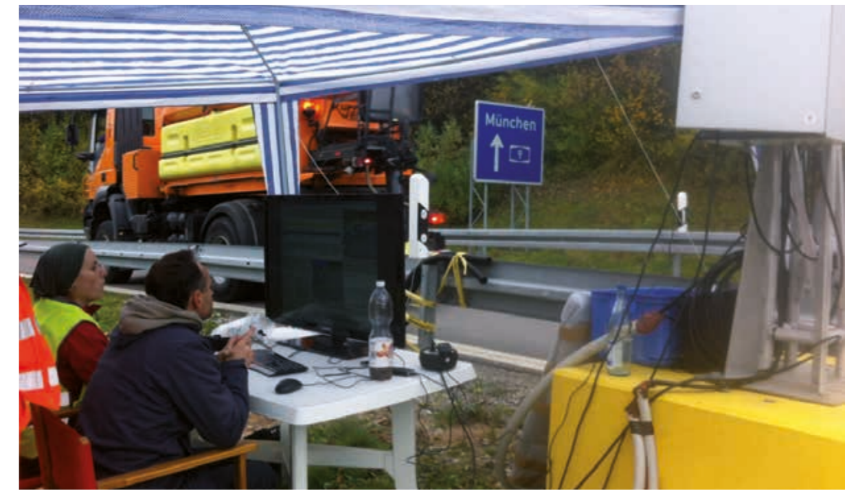
» Abb. 39 Referenzmessung vor Ort; hier: Sondersituation „Parkendes Fahrzeug im Messquerschnitt“
