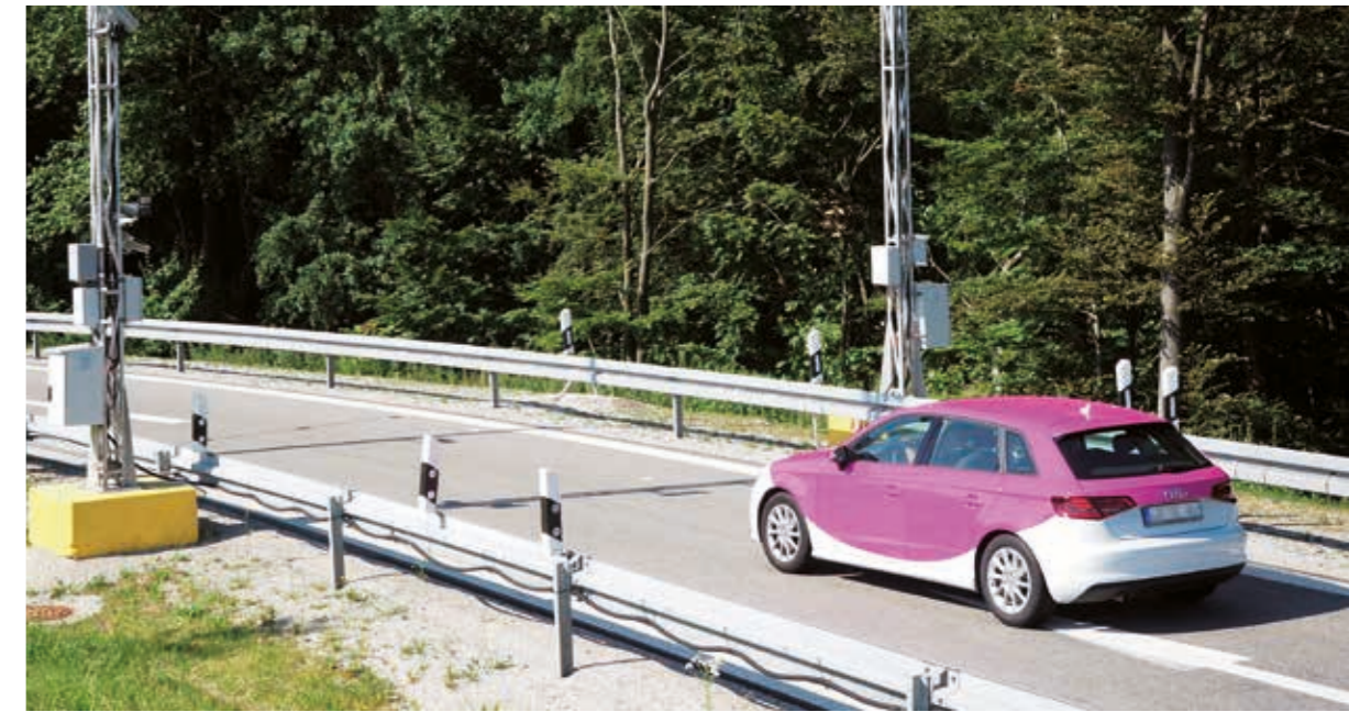
» Abb. 35 Aufbau eines Funkfelds mit sechs Leitpfosten
