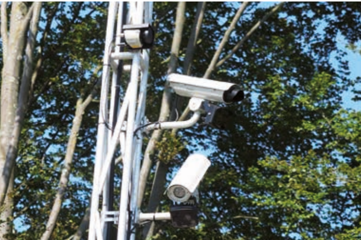
Aufbau Messquerschnitt Kamera und Laser
